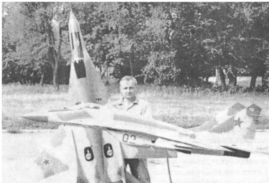
инженерным сооружением и самым дорогим направлением в авиа-моделизме. МиГ-29 в миниатюре создавался три с половиной года и потребовал больших капиталовложений. При этом было специально разработано несколько технологий. Планер модели полностью состоит из композиционных материалов (стеклопластик, углепластик) и изготовлен методом вакуумного формования. Автору удалось отобразить весь раскрой обшивки самолета, клепку, воссоздать интерьер кабины и даже экипировку пилота.
