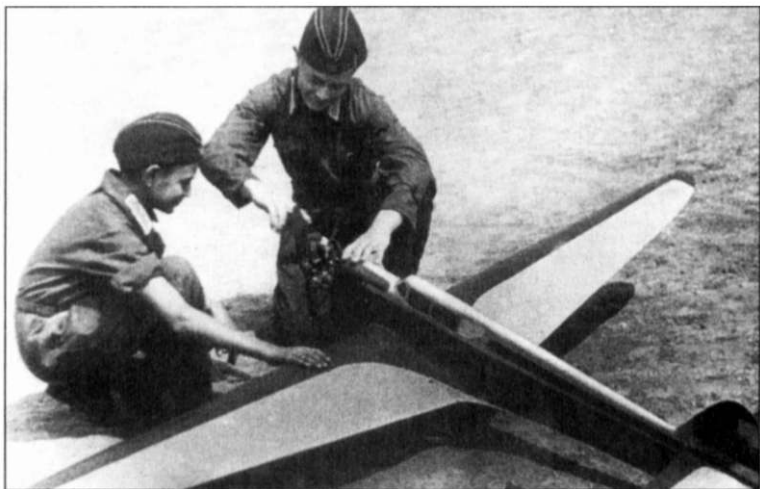
Первая модель с механическим двигателем, изготовленная харьковчанами. В 1934 г. модель установила рекорд Украины по дальности полета - 1126 м. На снимке: авиамоделисты Володя Томицкий и Александр Хлыстов готовят модель к полету,
